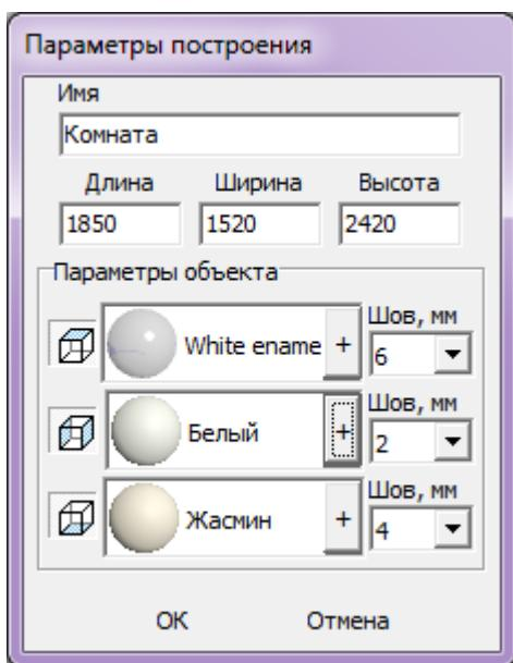
«**Имя**» - название объекта «помещение». «**Длина**», «**Ширина**», «**Высота**» - размеры помещения. («**Высота**» – высота от пола до потолка, немаловажный параметр, который также сильно влияет на расход плитки.)
