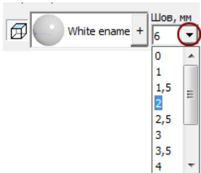
Если на **разных стенах** помещения нужен разный размер шва, это можно указать в процессе укладки плитки. Однако именно на этапе создания короба помещения указывается размер шва по умолчанию.
